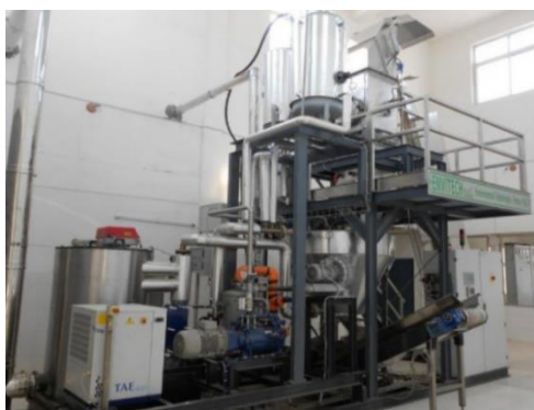
图 1 高温干热灭菌工艺设备
