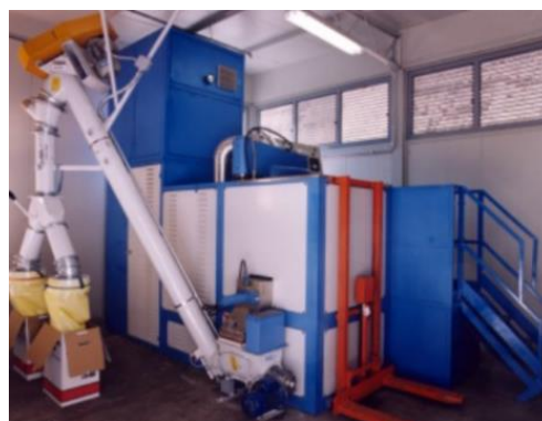
图 2 高温旋切灭菌工艺设备
