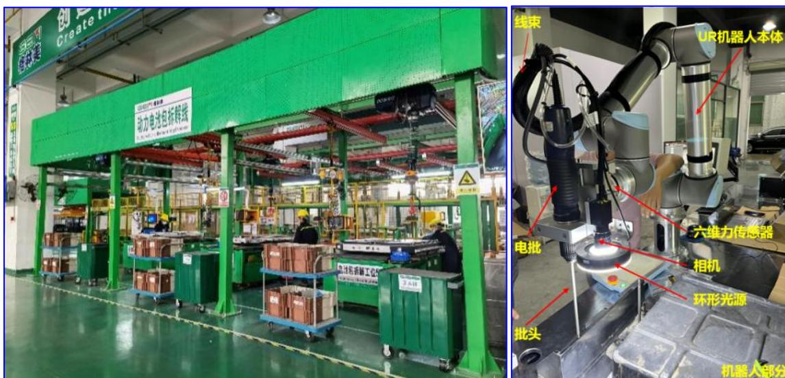
动力电池包智能拆解设备及动力电池柔性智能拆解系统
